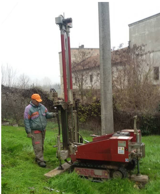
Figura 10: Esecuzione prova penetrometrica dinamica
