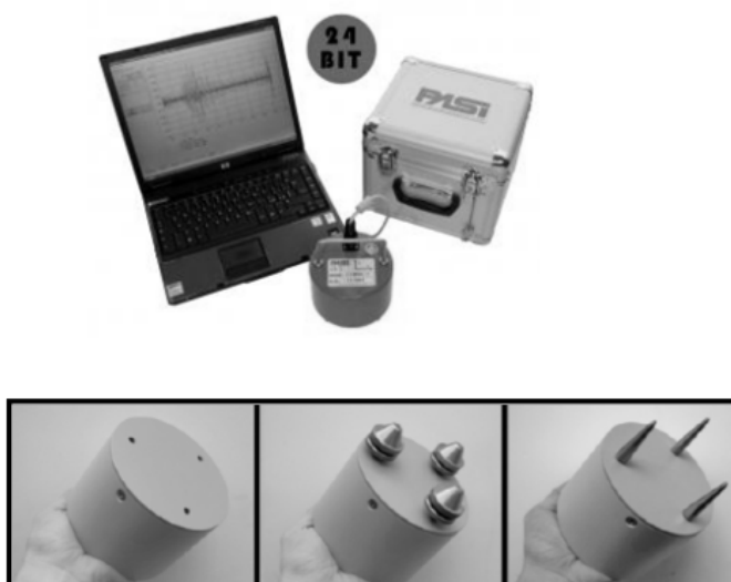
Figura B. 1 - Versione "GEMINI HVSr" basolare impiegata per la prospezione sismica passiva: dettaglio dei supporti intercambiabili in dotazione, da sostituire a seconda che si acquisisca su superficie rigida o su terreno.
